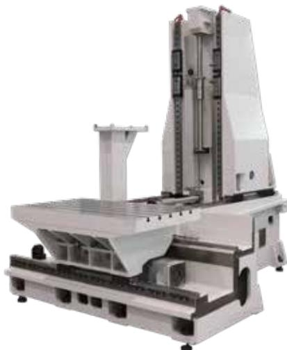
La concezione strutturale permette di esaltare le caratteristiche di rigidità del centro di lavoro nelle condizioni di estremo sfruttamento della potenza e coppia del motomandrino.
