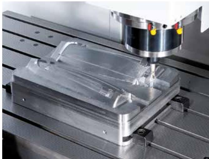
La configurazione a tavola mobile sull'asse X permette di valorizzare le caratteristiche di precisione e qualità finale dei particolari lavorati.
